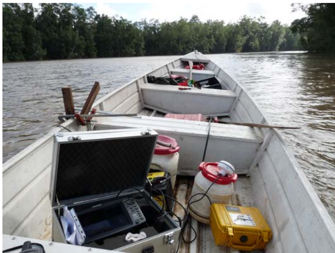
Figure 8. Bateau sur la crique Coswine équipé de la sonde (installée latéralement), GPS et écran du sonar.
